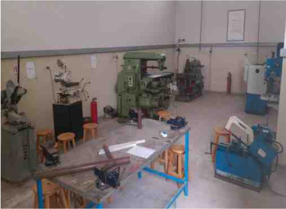
ورشة الماكينات: ماكينة خراطة - فرززة - مقشظة - مثقاب - حجر جليخ
